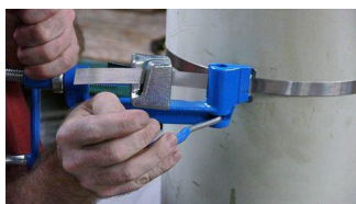
b) strumento per stringere la band-it al palo
