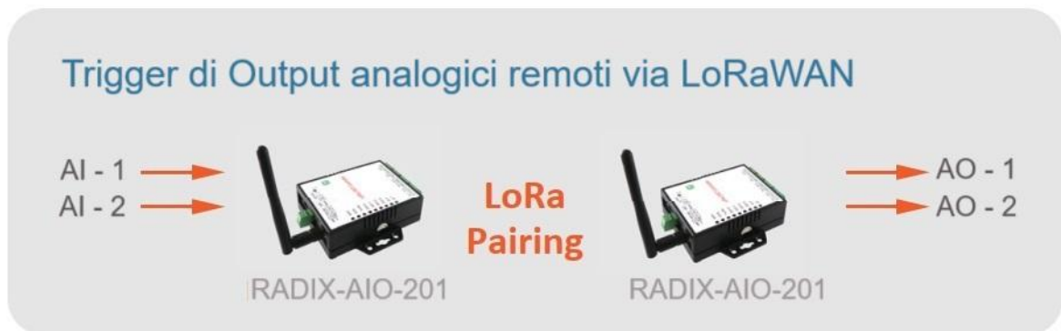
Fig. 4.4. Kit per la trasmissione via LoRaWAN di Input/Output analogici
