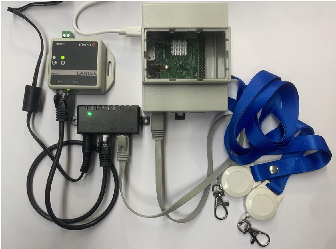
**Fig. 2.1.** Architettura del sistema ISM BLE AP
