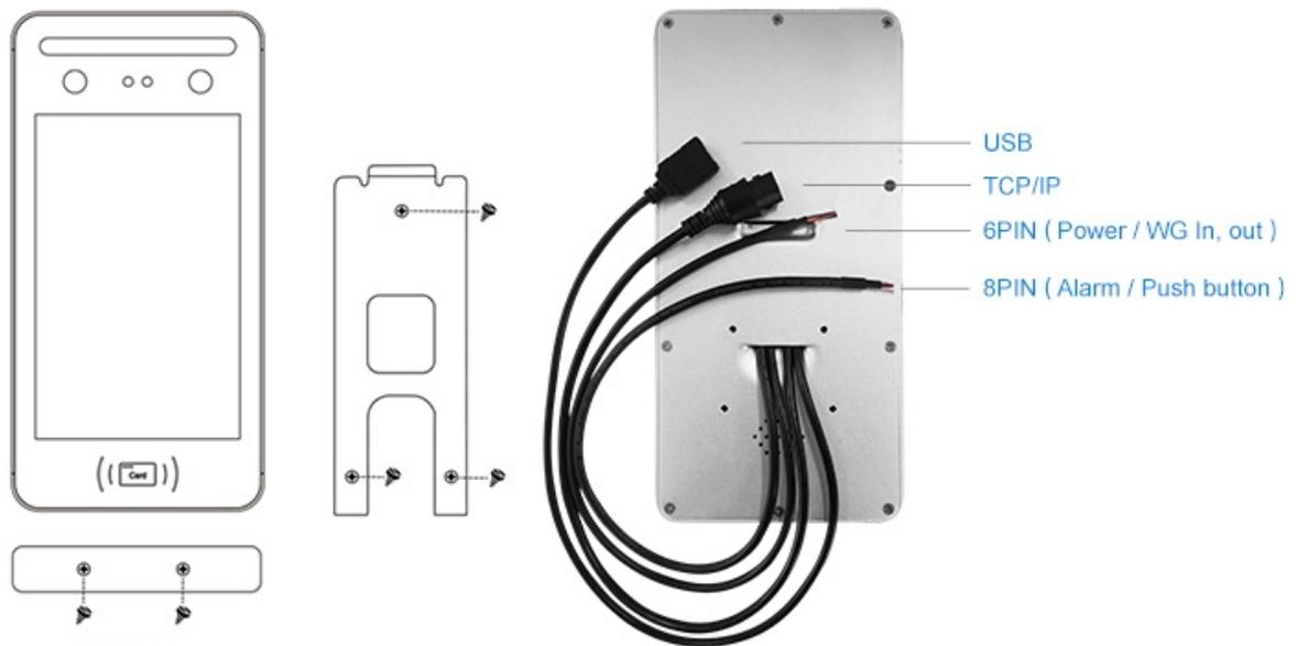
**Fig. 2.2.** Montaggio del terminale DF08
