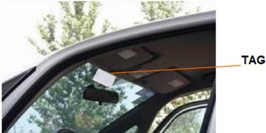
Fig. 3.4. Posa del TAG (area di non schermatura del parabrezza)
