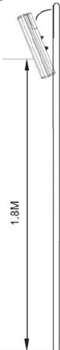
Fig. 3.2. Altezza e angoli di posa del lettore G3-245
