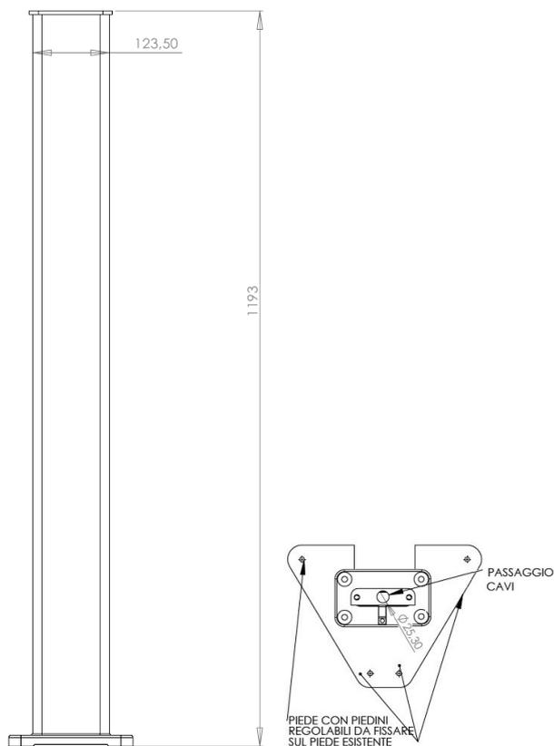
**Fig. 2.1.** Dimensioni colonna per terminale JVR100
