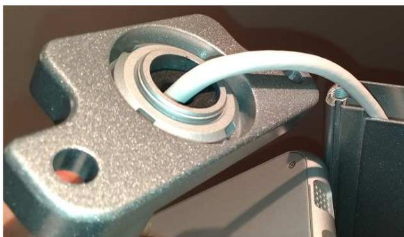
**Fig. 2.6.** Ghiera fissata all'appoggio superiore della colonna
