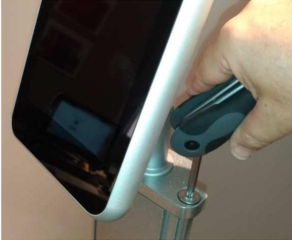
**Fig. 2.7.** *Fissaggio terminale JVR100-R con l'appoggio superiore alla colonna*
