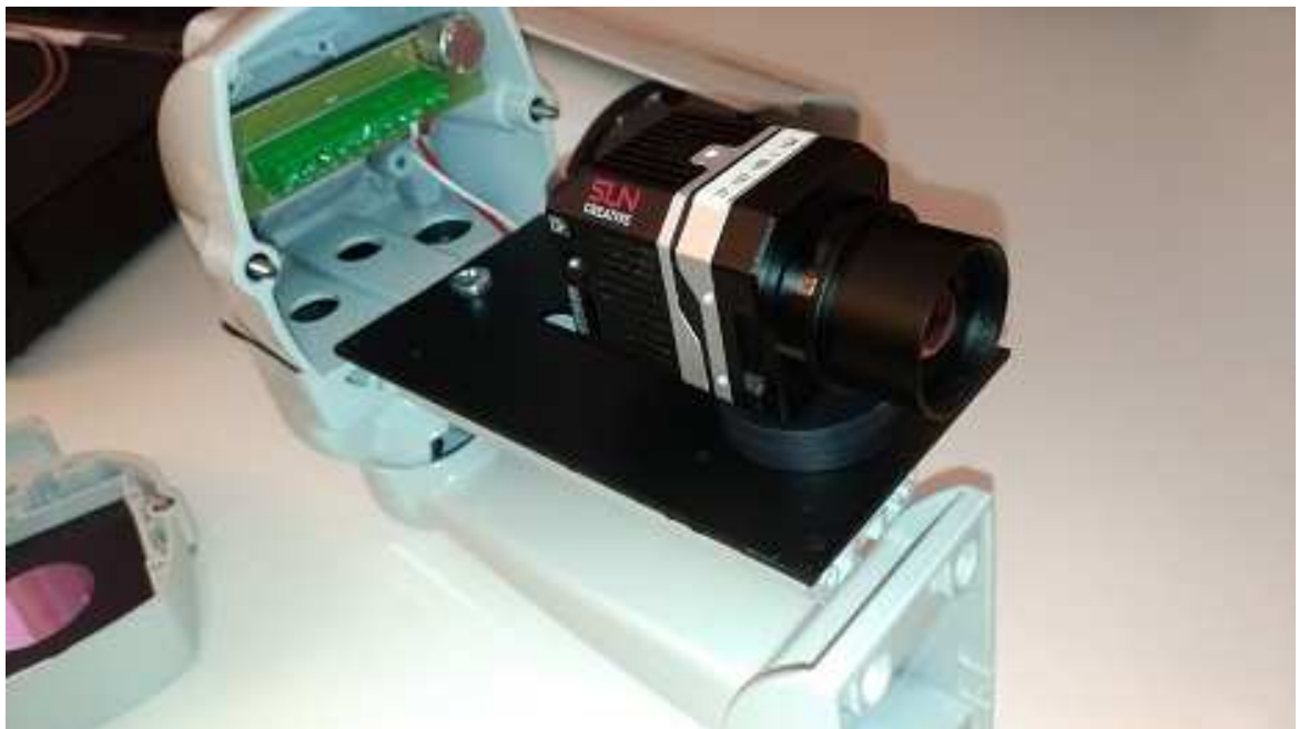
Fig. 2.3 a). Posizionamento telecamera termica sulla base della custodia
