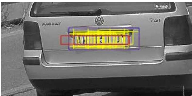
**Fig. 4.4.** Rilevamento targa nel frame
