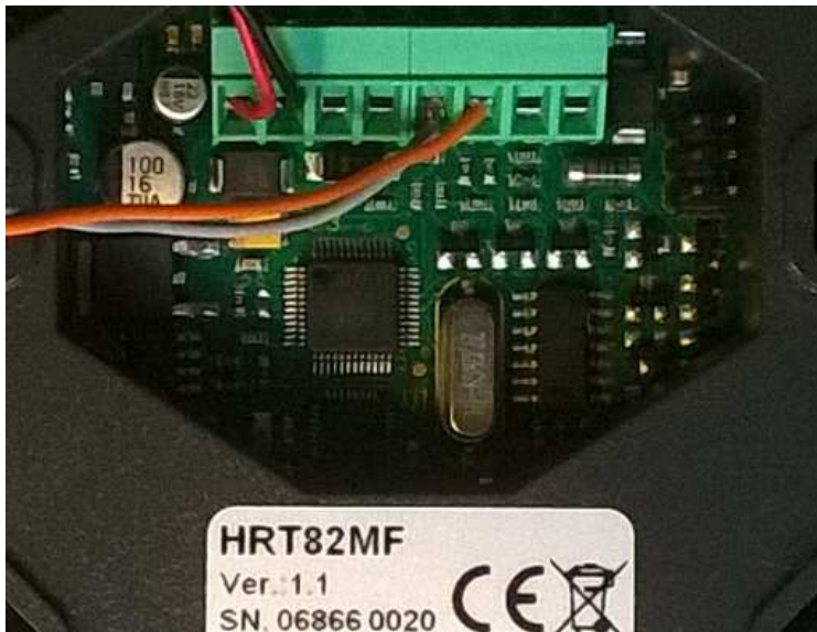
Fig. 2.4. Connessioni CLK-DTA per il lettore HRT82MF
