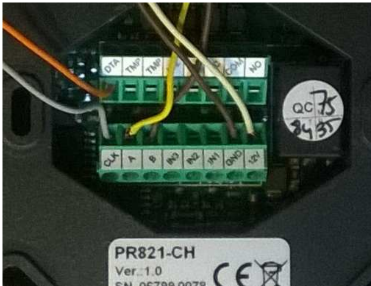
Fig. 2.2. Connessioni seriali della centralina PR821CH (A-B per RS485 e CLK-DTA per il lettore)
